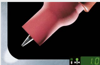
Hitsauspään halkaisija: 1 mm Perusaine: AlMg3 Levyn paksuus: 5 mm Hitsausvirta: 185 A Hitsausjännite: 15,6 V AC-tasapaino: -5
